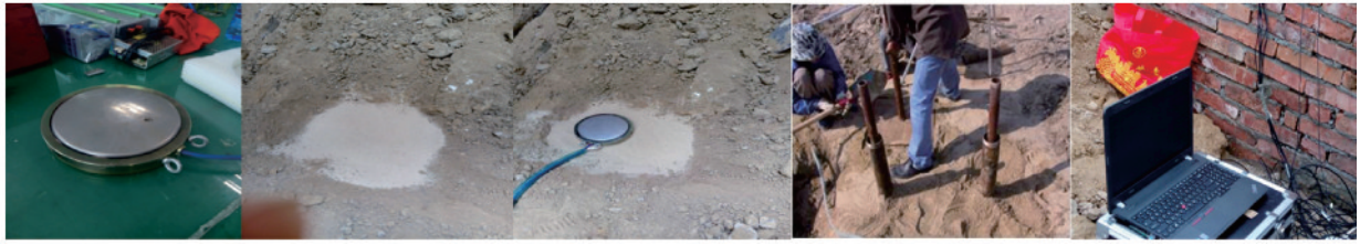
图2 测试元件埋设及数据采集照片
